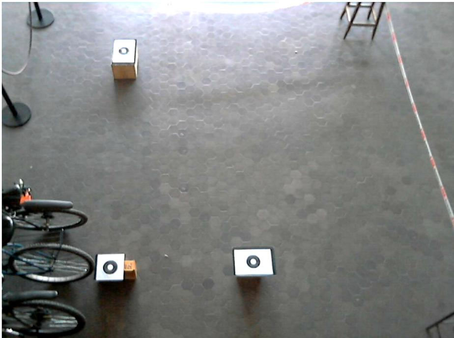
Fig. 6.3: Patrones dispuestos en forma de eje cartesiano. En base a este plano quedan definidas las posiciones del robot.
