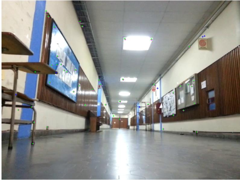
Fig. 5.5: Conjunto final de todos los puntos que fueron utilizados para las actualizaciones del estado para el paso actual. Se muestran aquellos puntos inliers seleccionados por RANSAC y sumados los outliers que fueron rescatados.
