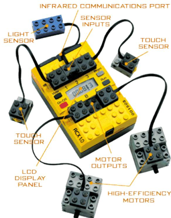
Figura 1 - Ladrillo RCX y sus componentes
