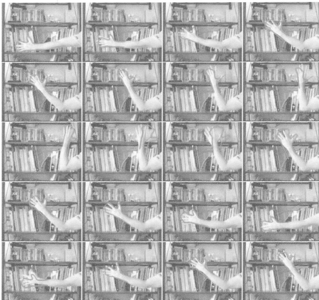
**Figura 6-19.** Seguimiento realizado con un modelo de estimación de movimiento aprendido a partir de la secuencia de video de la Figura 6-12. Esta secuencia de video es mucho más rápida que la empleada para el aprendizaje y gracias al modelo de estimación de movimiento el sistema no pierde al objeto.
