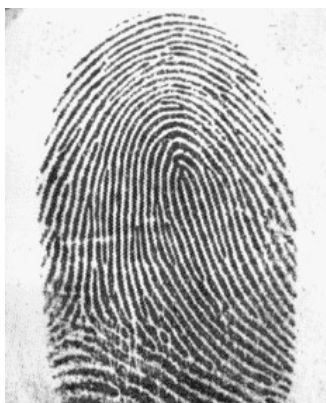
Figura 4-5: Huella pulsada (en un dispositivo basado en reflexión total)
