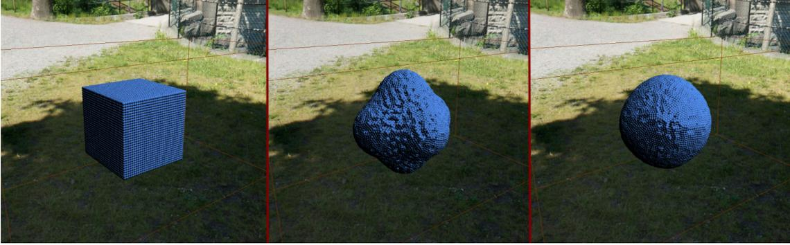
Fig. 3.2: Implementación del modelo en el presente trabajo. El cubo, por efecto de la tensión superficial, se transforma en una esfera. En la escena no hay gravedad.
