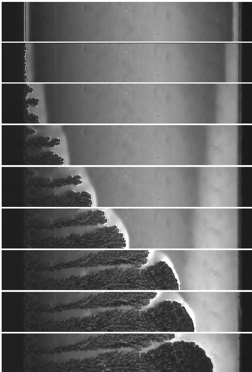
Figura 1.6: Similar a la figura 1.5, pero con concentración 0.3M, y con tiempos: 10, 30, 80, 130, 190, 250, 330, 350 y 390 segundos [34].
