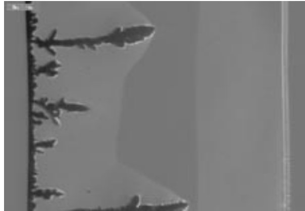
Figura 1.8: Desarrollo del depósito en un experimento a baja viscosidad (0 % de glyrecol). Se puede apreciar la distancia que existe entre las ramas.
