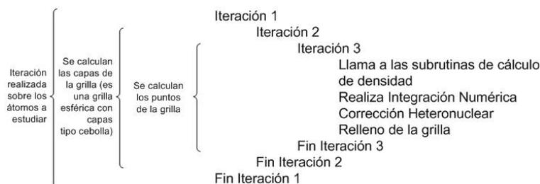
Figura 3.3: Iteraciones ejecutadas para completar la grilla RMM. Se optó por paralelizar el código a partir de la Iteración 1, la cual ejecuta los loops internos para cada uno de los átomos a analizar.
