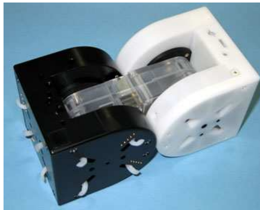
Figura 3.5: Módulo M-TRAN III.
