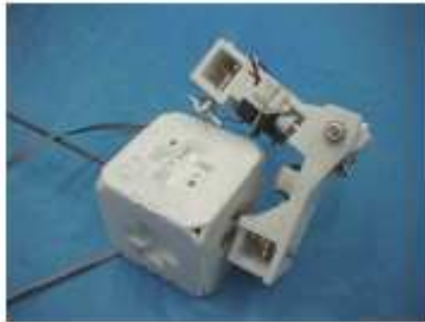
Figura 2.11: Módulos de tipo “cube” y “link” del robot I-Cubes.
