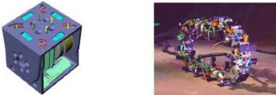
Figura 2.2: Esquema CAD de un módulo Polybot G2 (izquierda). Robot Polybot G2 en una estructura circular (derecha).
