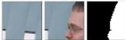
*fig. 14: Dos parches en la posición  $x, y$  en los momentos  $k_1$  y  $k_2$  respectivamente y su respectivo corte A, B en blanco y negro*
