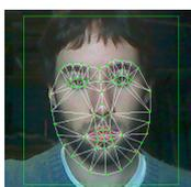
Se describe como obtener la pose inicial para el AAM, utilizando un clasificador en cascada entrenado con *Adaboost* y aplicando una transformación de rotación, traslación y escala al AAM.
