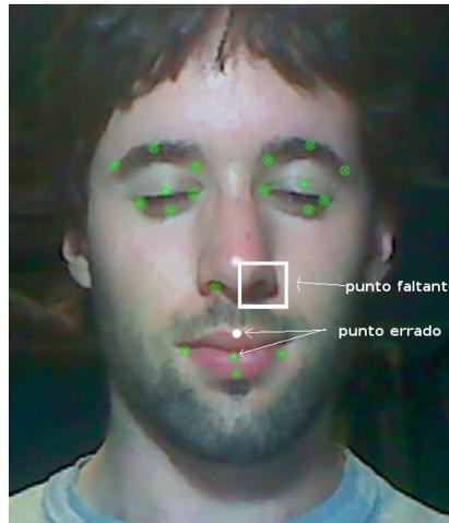
Figura 3.6: Ejemplo de un punto que no fue encontrado por el clasificador, y otro en una posición incorrecta.
