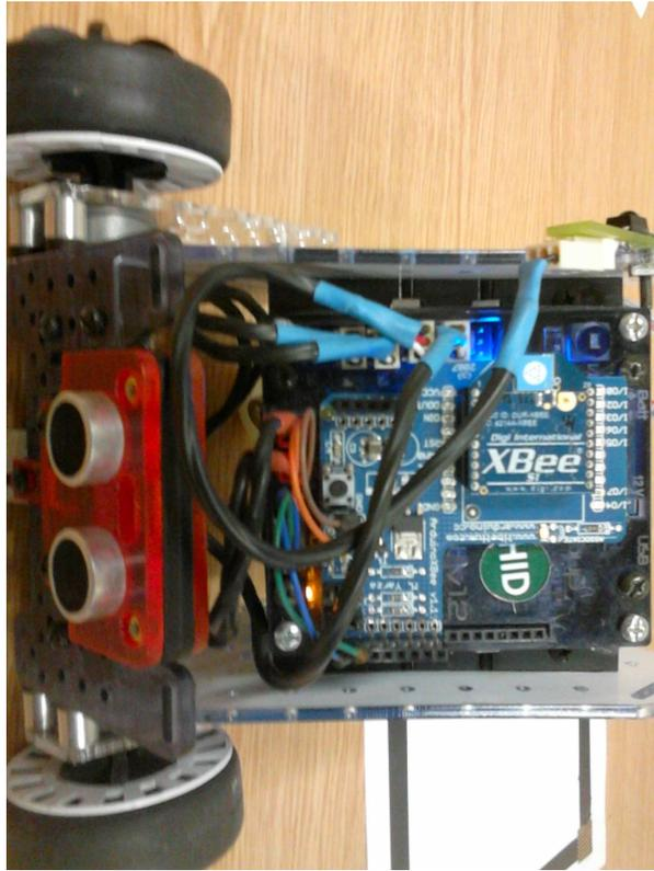
Fig. 5.2: Placa XBee adaptada al robot modelo N6
