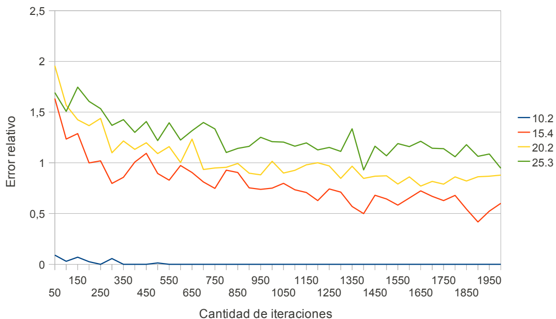
Figura 7: Error relativo dependiendo de la cantidad de iteraciones realizadas. Barrido lineal desde 50 a 2000.
