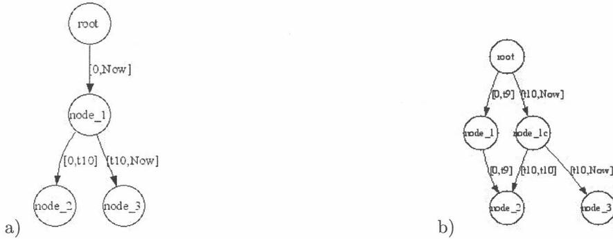
Figura 5.4: Ejemplo de duplicación del nodo node\_1 al instante  $t_{10}$ . a) Porción del documento antes de duplicar el nodo node\_1. b) Porción del documento luego de duplicar el nodo node\_1.
