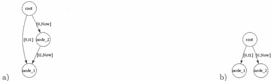
Figura 5.1: Ejemplo de eliminación de eje. a) Porción de documento antes de eliminar el eje (node\_2, node\_1). b) Luego de eliminar el eje
