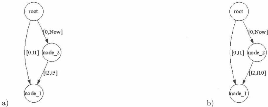
Figura 5.5: Ejemplo de expansión de un eje a un instante. a) Porción del documento antes de expandir. b) Porción del documento luego de la expansión.
